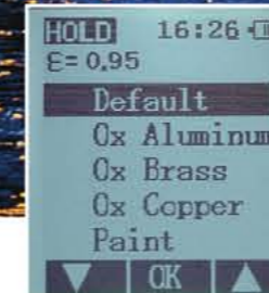
Настройка излучательной способности
